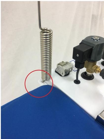
6- Instale la antena de sujeción del cable en el orificio correspondiente.
