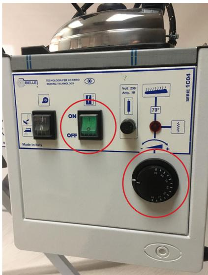
10- Accione el interruptor de la resistencia del plato y regule la temperatura con el termostato.
