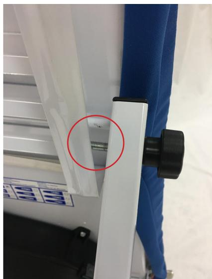
3- Enrosque el pasador de seguridad prestando atención a que este quede por encima de la barra de desplazamiento.
