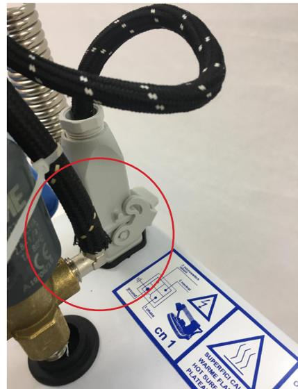
7- Conecte la clavija de la plancha y el tubo de vapor en la electroválvula. Fije el tubo de vapor en la electroválvula con la abrazadera suministrada.
