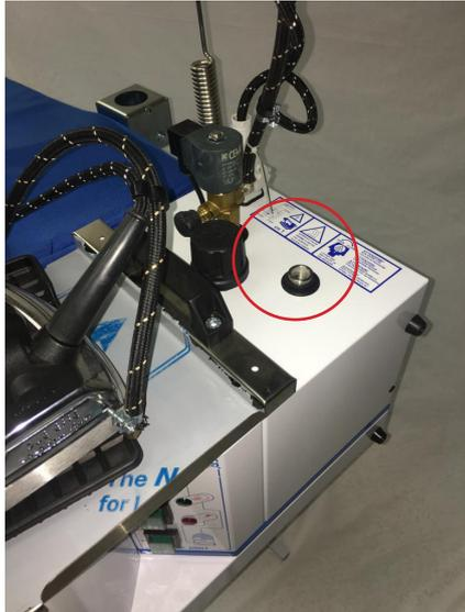
8- Desenrosque el tapón y llene la caldera. La capacidad útil de la caldera es de 4,2 litros. Enrosque el tapón hasta que note que hace junta. No apretar en exceso.
