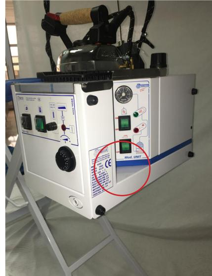
9- Accione el interruptor de la caldera y de la plancha situados en el lateral de la caldera.
